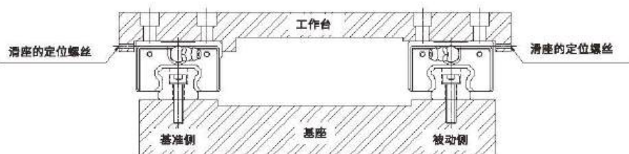
图6 基准侧导轨没有定位螺丝的情况
